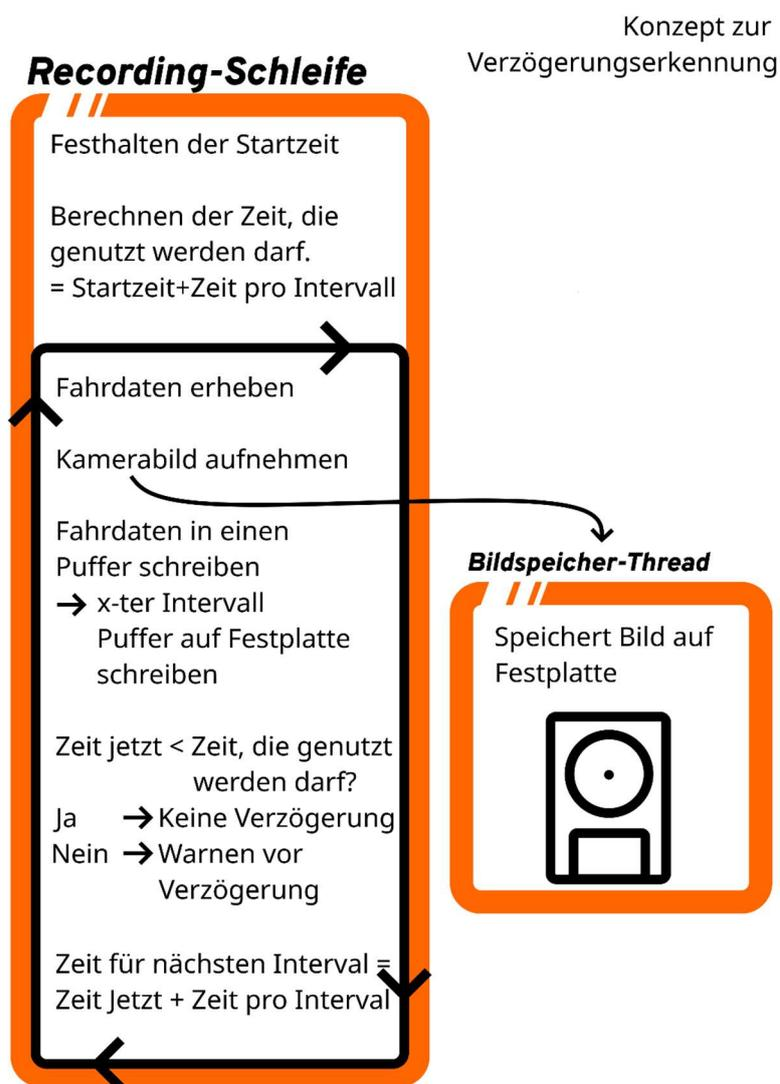
Abbildung 12 Konzeptgrafik Verzögerungserkennung Recording-Modus
