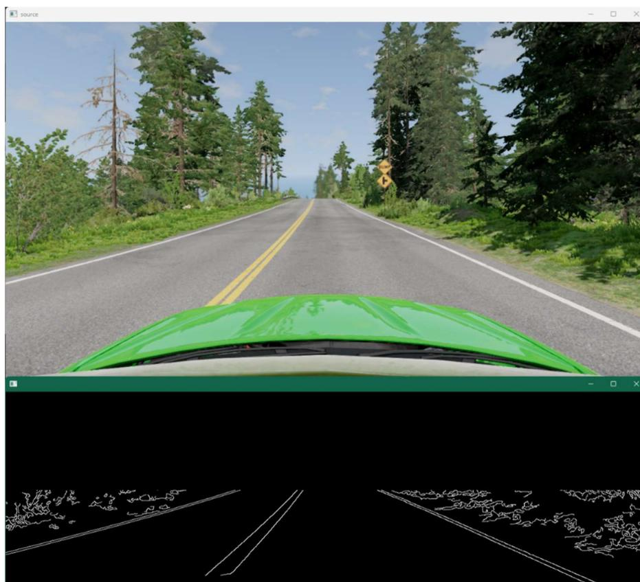
Abbildung 25 Vergleich Quellbild (oben) und Ergebnis "cv2.bitwise\_and" von Polygon und Canny Ergebnis (unten)
